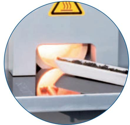
Feststoffanalytik im Modul HSC 1300: Kontaminationsfrei zu beschicken und gut zu verfolgen – dank Laminar Air Flow Probenschleuse
